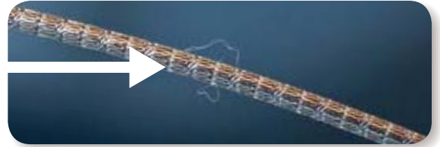
手袋を介してステントに付着した、コットンガーゼの繊維
